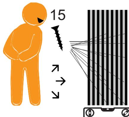
Mit Schrauben oder Kleber werden die Akustikplatten an der Wand montiert. Bei Montage an der Decke müssen immer Schrauben verwendet werden.
