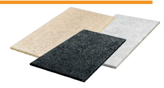
Die FibroTech Holzwolleplatten werden imWerk ofengetrocknet, sind aber möglicherweise externen Einflussfaktoren ausgesetzt, die dazu führen, dass die Platten Feuchtigkeit aufnehmen. Daher besteht die Gefahr, dass sie nach der Installation schrumpfen. Die FibroTech Holzwolleplatten müssen horizontal auf einer Palette oder mindestens 4 Balken gelagert werden.
